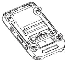
4. 液晶モニター丸で囲まれた部分を持ち、矢印の方向に回転させるようにして外す
