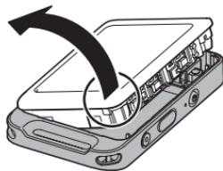
5. 図の部分に指を掛けて、持ち上げるようにして電池を外す
