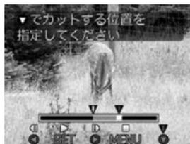
6. 操作4と同様に操作し、カットする終わりの場面が表示されたら【▼】を押します。
