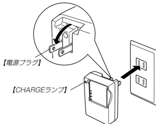
3. 充電が完了すると【CHARGEランプ】が緑色に点灯しますので、充電器をコンセントから取りはずし、その後充電器から電池を取りはずします。
