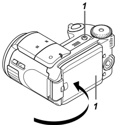
1. 【液晶モニター】を内側に向けて収納すると、自動的に電源が切れます。
