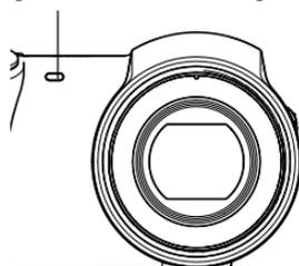
※ランプの点滅間隔は3種類あります。点滅1では1秒間に1回、点滅2では1秒間に2回、点滅3では1秒間に4回点滅します。
