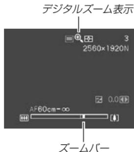
2. 【ズームレバー】をスライドさせて、光学ズームが最も望遠になると(ズームポインターが光学/デジタルズーム切替ポイントにくると)、いったんズーム動作を停止します。
