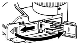
2. メモリーカードの表面を上(レンズ側)にして、【メモリーカード挿入口】に、「カチッ」と音がするまでしっかり押し込みます。
