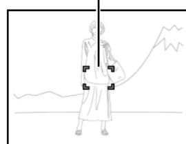
シャッターを半押しすると、カメラを向けている被写体に対して自動的に露出やピントを合わせます。どのくらいの力で押し込むと半押しになるか覚えるのが、きれいな静止画を撮影するコツです。
