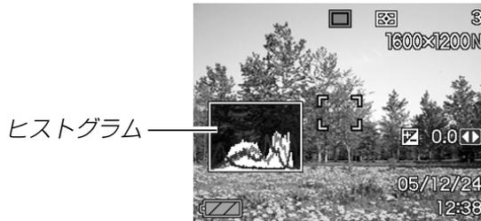
ヒストグラム(輝度成分分布表)とは、画像の明るさのレベルをピクセル数によりグラフ化したものです。縦軸がピクセル数、横軸が明るさを表します。ヒストグラムを見ると、補正するために十分な画像のディテールが画像のシャドウ(左側)、中間調(中央部分)、ハイライト(右側)に含まれているかどうかを確認することができます。もしもヒストグラムが片寄っていた場合は、EVシフト(露出補正)を行うと、ヒストグラムを左右に移動させることができます。なるべくグラフが中央に寄るように補正をすることによって、適正露出に近づけることができます。さらにR(赤)、G(緑)、B(青)の色成分が独立したヒストグラムも同時に表示されますので、色ごとに「赤成分がオーバー」「青成分がアンダー」のように各色の分布状況も直感的に把握することができます。
