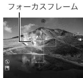
シャッターを半押しすると、カメラを向けている被写体に対して自動的に露出やピントを合わせます。どのくらいの力で押し込むと半押しになるかを覚えるのが、きれいな静止画を撮影するコツです。
