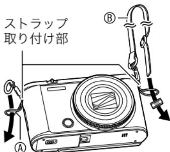
3. リング部分Ⓐのリングに、ネックストラップの先端を通して取り付ける
