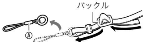
2. 取り外したネックストラップのリング部分ⒶとネックストラップⒷを、それぞれカメラの両端にあるストラップ取り付け部に取り付ける
