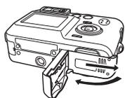
2. カメラを傾けて電池を取り出します。
