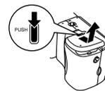
2. 電池を図のようにセットした後、【電池ボタン】を矢印の方向へ押しつけながら、スライドして閉めます。
