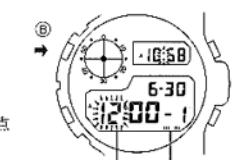
(3) このとき、⑥ボタンを押すごとに以下のように点滅箇所が移動します。点滅箇所がセット可能となりますので、⑥ボタンでセットしたい箇所を選びます。
