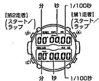
第1走者の計測スタート後、第2走者の計測をスタートさせると、時間差が4秒間表示されます。(この間内部では計測を続けています)
