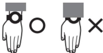
腕につけているときは、文字板(ソーラーパネル)に衣類の袖がかからないように心がけてください。文字板(ソーラーパネル)が一部でも隠れていると発電効率が低下します。
