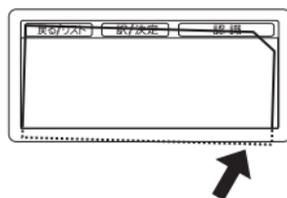
※保護フィルムは、パネルの枠内に正しく貼り付けてください。
