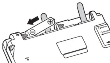
②取り出し用リボンの上に電池が載るようにして、(+) 極側をケースに押し込みます。
