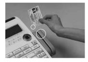
**2** 写真のように磁気カードリーダのスリット (溝) にカードを入れます。
