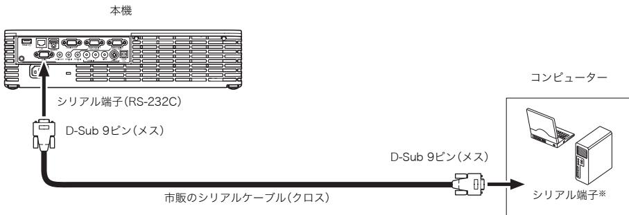
\*コンピューターのシリアル端子の形状はD-Sub 9pin(オス)が一般的ですが、異なる形状の場合もあります。コンピューターと市販のシリアルケーブルの接続方法については、コンピューターに付属の説明書を参照してください。
