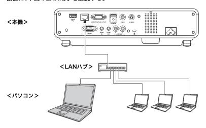
●上図のような接続では、一般にストレートタイプのLANケーブルを使用します。本機のLAN端子とパソコンのLAN端子を直接接続する場合は、クロスタイプのLANケーブルを使用してください。
