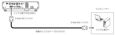
※コンピューターのシリアル端子の形状はD-Sub 9ピン(オス)が一般的ですが、異なる形状の場合もあります。コンピューターと市販のシリアルケーブルの接続方法については、コンピューターに付属の説明書を参照してください。
