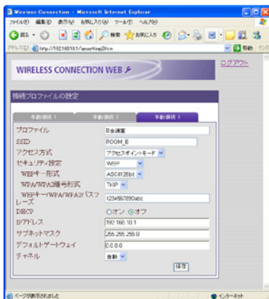
プロジェクター側の手動接続設定画面 (「接続プロファイルの設定」ページ)
