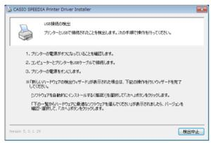
USBプリンター接続の検出(図USB-1)が表示されたら、次の手順でUSBケーブルを接続し、プリンターの電源をONにします。
