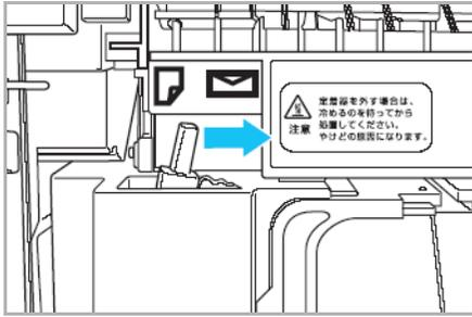
3. 定着切り替えレバーを封筒（右）側に倒します。
