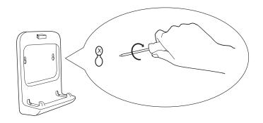
**8** スタンド本体を軽く引っ張り、確実に固定されていることを確認します。定期的に取り付け状態を確認してください。
