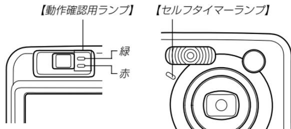
※ランプの点滅間隔は3種類あります。点滅1では1秒間に1回、点滅2では1秒間に2回、点滅3では1秒間に4回点滅します。
