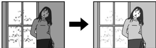
【▼】：－方向に補正されます。黒い物の撮影や晴天の野外などのときに押します。
