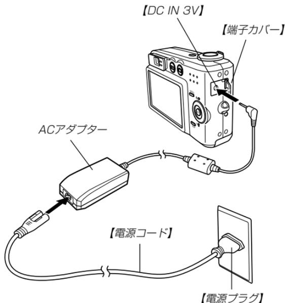
2. カメラの【端子カバー】を開き、【DC IN 3V】にACアダプターのプラグを接続します。
