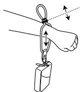
• スポンのベルト通しなどに吊るすとき、フックを使用して吊るし、ストッパーでカメラの位置を調整できます。
