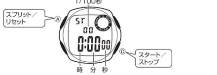
★計測中にⓐ ボタンを押すと、表示は止まりますが、内部では計測を続けるスプリット計測となります（“SPL”表示）。
