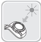
腕につけているときは、液晶画面(ソーラーパネル)に衣類の袖がかからないように心がけてください。液晶画面(ソーラーパネル)が一部でも隠れていると発電効率が低下します。
