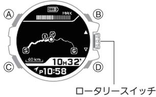
2. ロータリースイッチを回して、縮尺を変更します。
