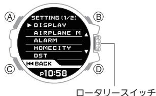
2. ロータリースイッチを回して、[ALARM]にポインターを合わせます。
