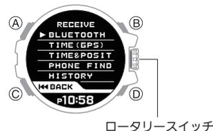
2. ロータリースイッチを回して、[BLUETOOTH] にポインターを合わせます。
