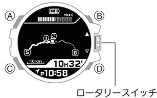
2. ロータリースイッチを回して、[BACKTRACK] にポインターを合わせます。
