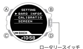
2. ロータリースイッチを回して、[CALIBRATION] にポインターを合わせます。
