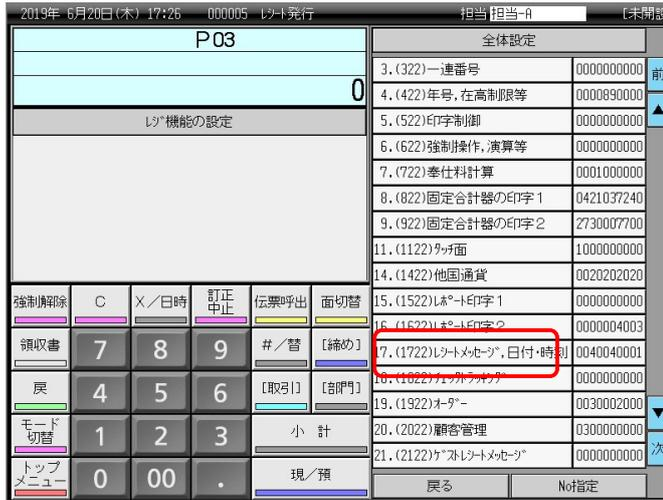
⑦ <次> をタッチして<レシートにボトムメッセージ>を「印字」に設定し<決定>をタッチします。
