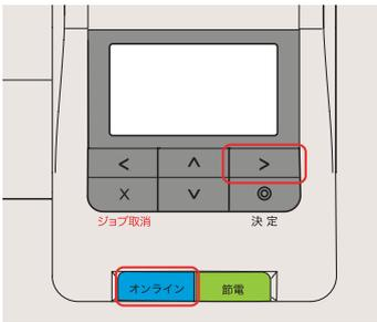
2. **▲▼** ボタンを押して「立ち上げモード」、「モノクロ専用」の順に選択し、**◎**（決定）ボタンを押します。
