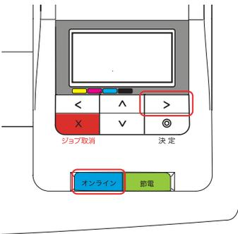
1. 操作パネルの「オンラインボタン（GE5500 / 5000 シリーズ）」を押し、**▲▼** ボタンを押して「機器設定」を選択し、**>** ボタンを押します。
