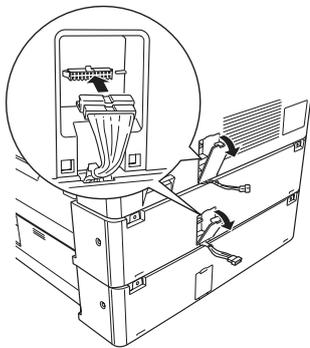
4. 本体、拡張ペーパーフィーダセットそれぞれに固定金具を差し込み（2ヶ所）、ネジ止めします。
