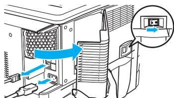
1. 本体の電源スイッチをOFFにして、背面のインターフェースカバーを取り外します。
