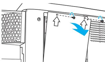
2. 金属のシールド板のネジ2本（↑ 刻印の場所）をゆるめてシールド板を取り外します。
