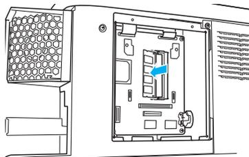
4.取り外した時と逆の手順でカバーを取り付けます。
