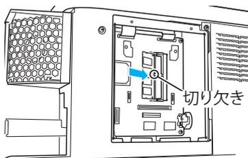
3. 増設メモリーをソケットに差し込み、カチッと音がするまで押します。
