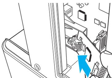
4. USBホスト拡張ボードを取り付け台（黒い樹脂の台）の上面にスライドさせながら奥まで差し込みます。
