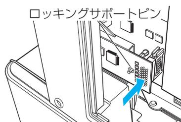
5. イラストの矢印部分を押し、USBホスト拡張ボードとロッキングサポートピン（白）に差し込みます。
