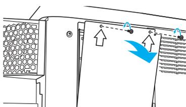
3. 金属のシールド板のネジ2本（↑ 刻印の場所）をゆるめてシールド板を取り外します。
