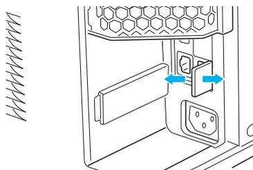
2. イラストの目隠し板（グレーの樹脂）を数回折り曲げて取り外します。
