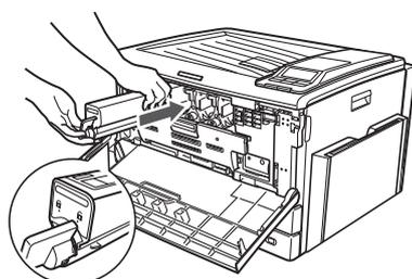
7. トナーシールテープを剥がした面を下にして本体に差し込み、取り出しと逆の手順でトナーセットを取り付けてフロントカバーを閉めます。
