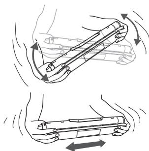
5. 新しいトナーセットを梱包箱から取り出して、イラストのように上下左右に数回振ります。
