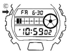
※秒(時刻・カレンダー)セット状態で表示を点滅させたままにしておくと、2~3分後自動的に点滅が止まり、時刻・カレンダーモードに戻ります。
