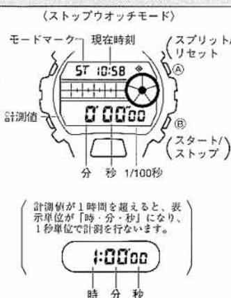
★計測中に⑥ボタンを押すと、スプリット計測となります。もう一度⑥ボタンを押すとスプリットが解除されます。
