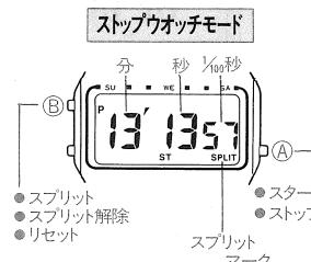
※積算計測……ロストライムのある場合には、ストップ後リセットせずに再スタート(Ⓐボタンを押す)すれば表示タイムに引き続き計測をはじめます。
