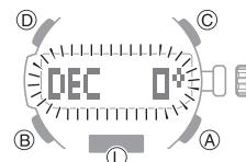
4. りゅうずを回して、磁気偏角の方角と角度を設定します。
