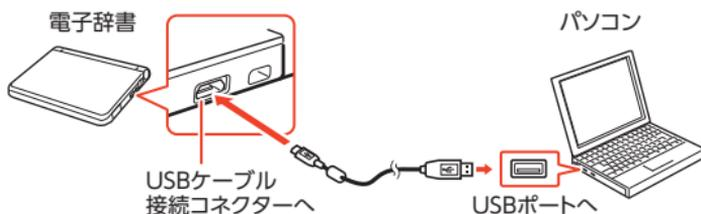
• 挿し込む向きに注意して、USB ケーブルを接続してください。
