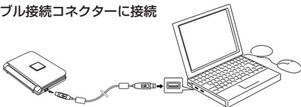
※必ずパソコン本体のUSBポートに接続してください。パソコン本体以外のUSBポートでは正常に動作しない場合があります。
