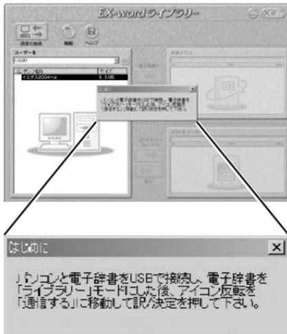
3 電子辞書の **通信する** を2回押して「通信する」を選び、**戻/決定** を押します。
