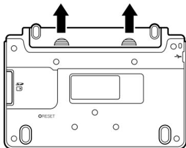
4 電池収納部から古い電池を取り出して、新しい電池をセットし、電池ブタを取り付けます。
