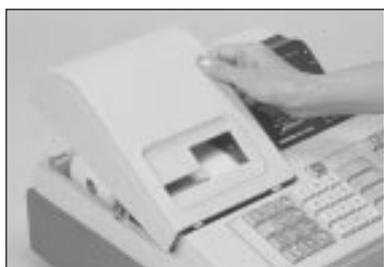
⑥レシート用ロールペーパーを元の位置に戻し、プリンターカバー前面のツメを所定の穴に入れてからカバーを閉じます。
