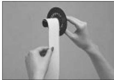
⑤ 付属品の「ジャーナル巻き取りホルダー」の溝に、ロールペーパーの先端を差し込み、2～3回巻き付けます。
