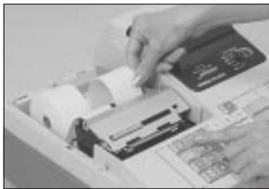
③ ロールペーパーの先端を「ジャーナル用紙挿入口」へ、奥深く差し込みながら「ジャーナル送り」キーを押し続けます。
