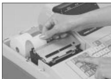
⑤ ロールペーパーの先端を「レシート用紙挿入口」へ、奥深く差し込みながら「レシート送り」キーを押し続けます。
