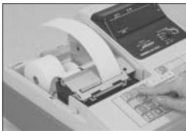
④ 「ジャーナル用紙排出口」からロールペーパーの先端が出てきます。ペーパーが 20 cm 位出るまで「ジャーナル送り」キーを押し続けます。
