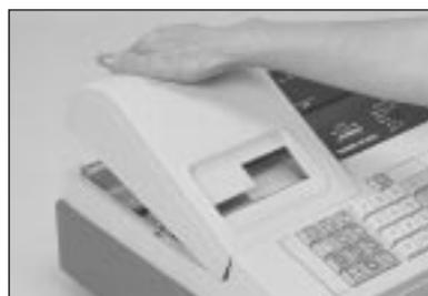
② プリンターカバーの後方部を持ち上げて、カバーを取り外します。
