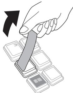
**2** キー本体からキーキャップを外し、中のキープレートを取り出します。新しいキープレートにキーキャップの中に入れ、紙の方向に注意しながらキー本体にかぶせて押し込みます。
