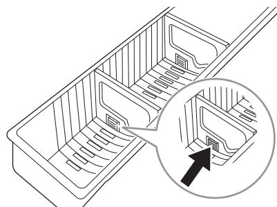
2 コイン仕切り板を取り付ける箇所の溝に合わせて差し込み、フックがかかるところまで押し込みます。
