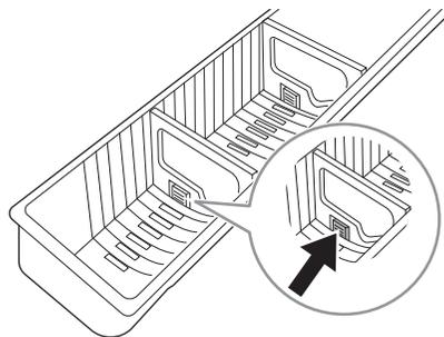
**2** コイン仕切り板を取り付ける箇所への溝に合わせて差し込み、フックがかかるところまで押し込みます。
