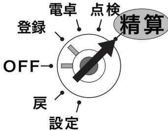
モードスイッチの位置を「点検」または「精算」にすると、本体表示にメニューが表示されます。を押して精算する項目にカーソルを合わせ、を押します。
