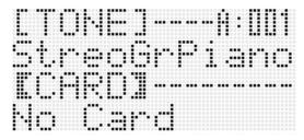
"No Card" の表示は、カードスロットにカードが挿入されていないときに現れます。カードが挿入されているときの表示については、103ページ「カード上の楽曲ファイルを再生する」をご参照ください。
