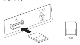
**2.** 取り出すときは、カードをさらに押し込みます。 ロックが外れて、カードが少し押し出されます。出てきた 部分をつまんで引き抜きます。
