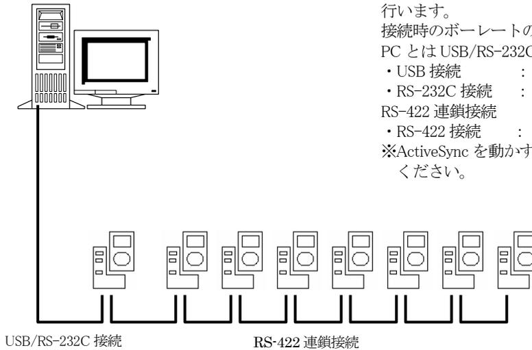
RS-422 ケーブルを使用して、最大 8 台の連鎖接続を行います。
