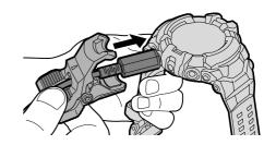
ホルダーを本体へ取り付ける。Attach the cable holder to the smartwatch body.
