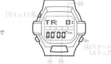
●計測を一時的に中断するには、①ボタンを押します。もう一度①ボタンを押すと、その時点から計測を再開します。
