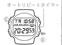
★計測中に②ボタンを押すと計測が一時的に中断します。もう一度②ボタンを押すとその時点から計測を再開します。
