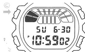
※秒(時刻・カレンダー)セット状態で表示を点滅させたままにしておくと、2~3分後自動的に点滅が止まり、時刻・カレンダーモードに戻ります。
