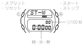
計測中に①ボタンを押すと、表示は止まりますが内部では計測を続けるスプリット計測となります。スプリット計測を解除するには、もう一度①ボタンを押します。
