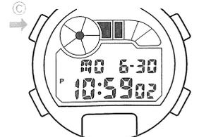
※秒(時刻・カレンダー)セット状態で表示を点滅させたままにしておくと、2~3分後自動的に点滅が止まり、時刻・カレンダーモードに戻ります。
