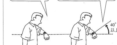
②水平状態から、表示が見えるように約40°傾けます
