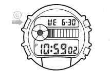
※秒(時刻・カレンダー)セット状態で表示を点滅させたままにしておくと、2~3分後自動的に点滅が止まり、時刻・カレンダーモードに戻ります。
