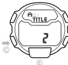
※タイトルの入力がすべて終わりましたら、㊦ ボタンを押して点滅箇所をメモデータ部に移動させます。(右図)
