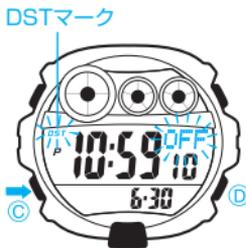
※ サマータイムをONにすると、テレメモモード以外の各モードでDSTマークが点灯します。
