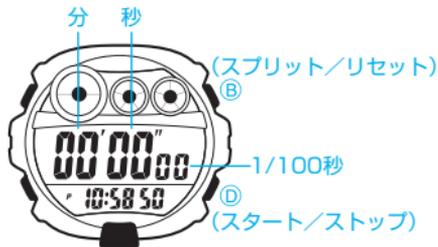
★計測中に**ⓑ** ボタンを押すと、表示は止まりますが、内部では計測を続ける**スプリット計測**となります。（“SPLIT”マーク点灯）
