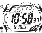
→ⒶまたはⒷボタンを押すと点滅箇所が移動しますので、合わせたい箇所を点滅させます。
