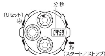
★計測ストップ後 **A** ボタンを押すと、計測前の表示に戻ります(リセット)。
