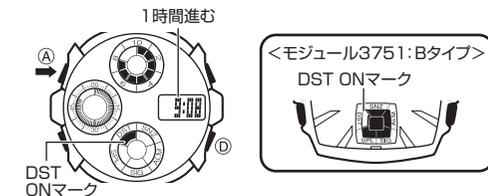
※DST ONマークが点灯しているときに、**Ⓐ**ボタンを約2秒間押すと通常の時刻に戻ります。
